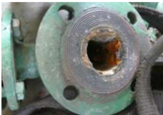
Obr. č.5 – Nárůst slávičky na armatuře výtlačku prosáklé vody
