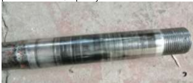
Obr. č.4. – Poškozená funkční plocha přívodní trubky
