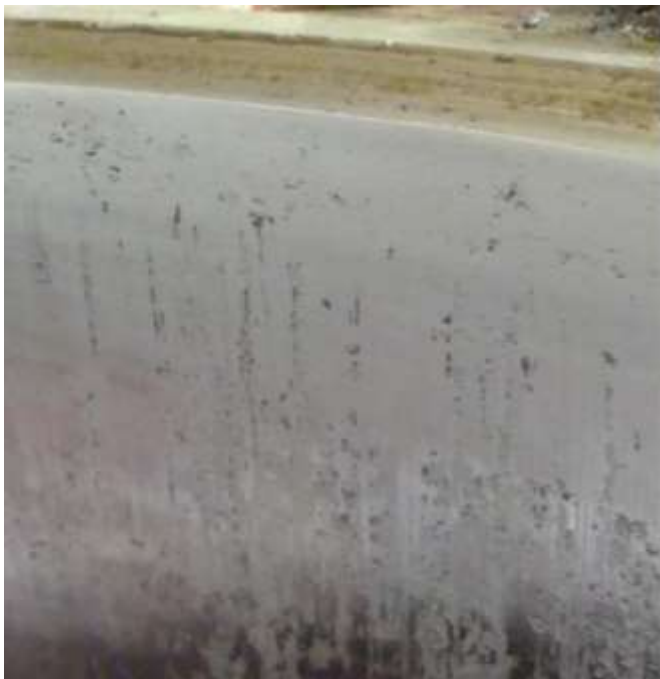
Obr. č. 3 – Poškození funkčních ploch náboje oběžného kola
