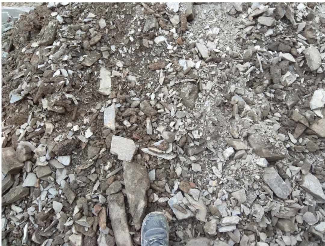
Fragmentace hornin po vytěžení bagrem, mezi šachtou 1.07 a 1.08
