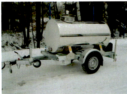
Ilustrační foto : Přívěs B1, nerezová cisterna 1000 l izolovaná
