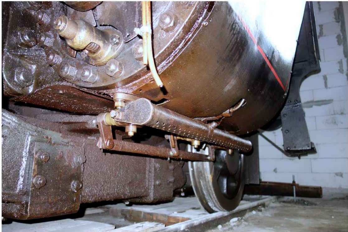
Obr. 23 Tlumič odvodňovacích kohoutů pravého válce. Oplechování válce vykazuje drobné závady (chybějící šroubky, deformace, nadbytečné výřezy a pod.)
