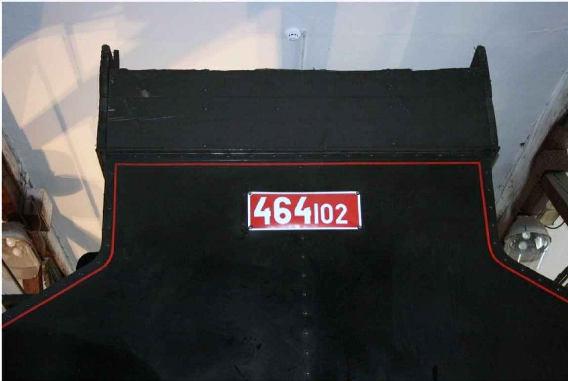
Obr. 35 Uhlák je zvýšen prkennou nástavbou, která byla za provozu (při zbrojení) poškozena drapákem jeřábu. Nástavba se opraví.
