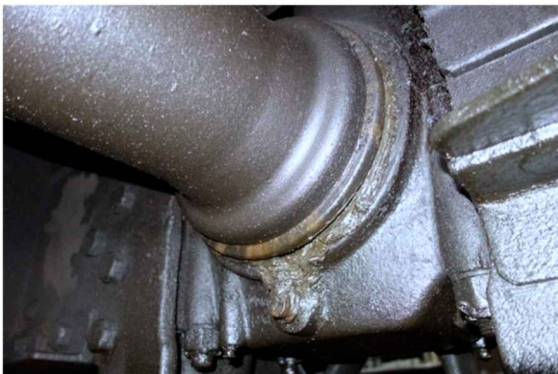
Obr. 28 Mazací tuk vystupující z válečkového ložiska na nápravě B4. Všech osm ložisek pochází z roku 1940 a lze předpokládat, že jsou na konci své životnosti.
