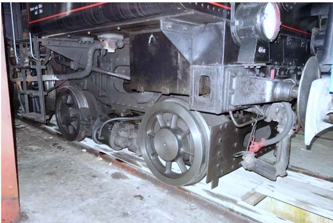
Obr. 27 Zadní podvozek pod tendrem je narozdíl od předního obrzděn. V nářad'ové skřínce nad kolem se nachází přípojovací hrdlo pro požární hadici. Identické je na druhé straně.
