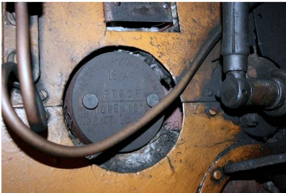
Obr. 42 Originální kotelní štítek se nezachoval. Při opravě lokomotivy v letech 1996 – 1997 byl nahrazen jednoduchou kopií, která se na kotli ponechává.
