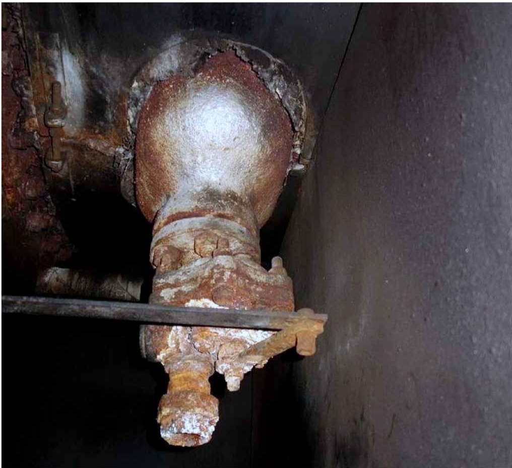
Obr. 18 Bahník s ručním odkalovacím šoupátkem na zadním kotlovém kroužku. Výpust postrádá trubku.
