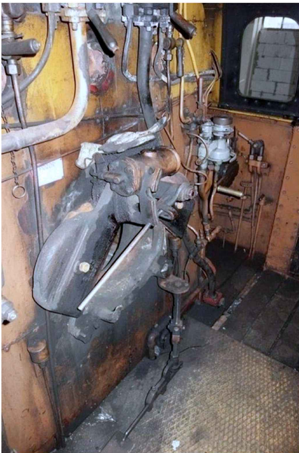
Obr. 38 Dveřnice kotle s topnými dvířky Butterfly. Mechanismus dvířek bude třeba opravit, neboť vykazuje značné vůle.
