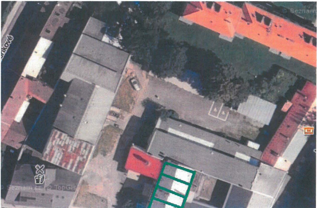
Obr.1 – zeleně vyznačená část střechy k určená k opravě
