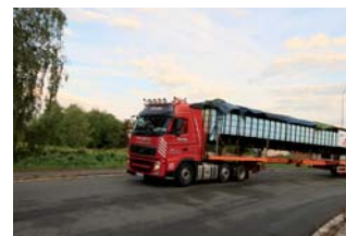
5. přeprava montážní jámy v režimu nadrozměru
