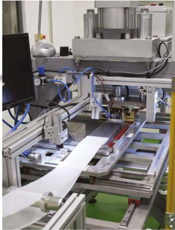
Obr. 8.: Ukázka technologie mechanického lisování ve step-and-repeat režimu. Kovový lisovací nástroj je pod tlakem v kontaktu s plastovou podložkou pulzně zahřátý na vysokou teplotu a dochází k velmi věrné replikaci reliéfu na jeho povrchu (schéma vlevo nahoře). Na obrázku vlevo dole je ukázka optických prvků přenesených do PMMA podložek. Na obrázku vpravo je část speciálního zařízení pro mechanické lisování reliéfních optických struktur.
