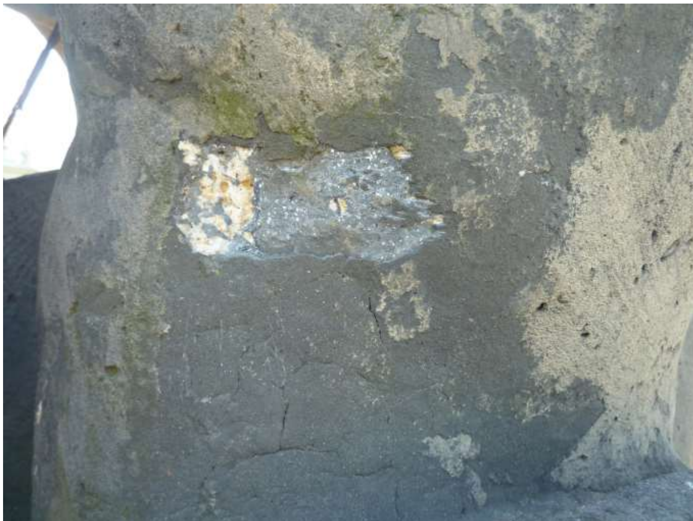
Sousoší Alegorie Dionýsa. Detail levého boku trupu sochy. Silná popraskaná vrstva černého cementového tmelu.
