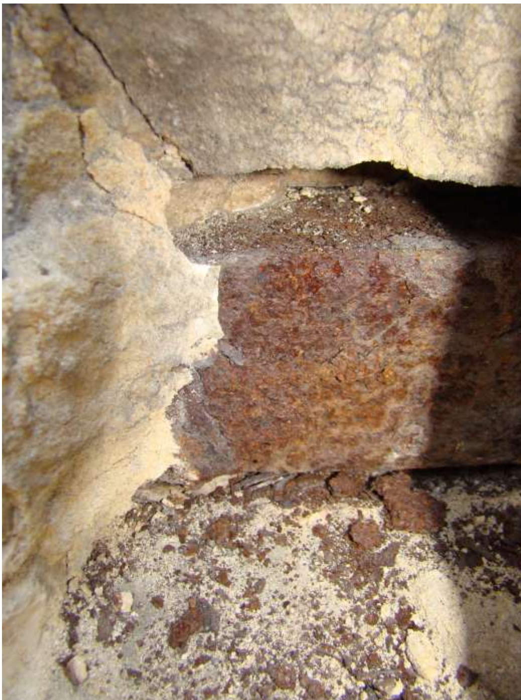
Korodující čep levého kola. Roztržený náboj kola - detail
