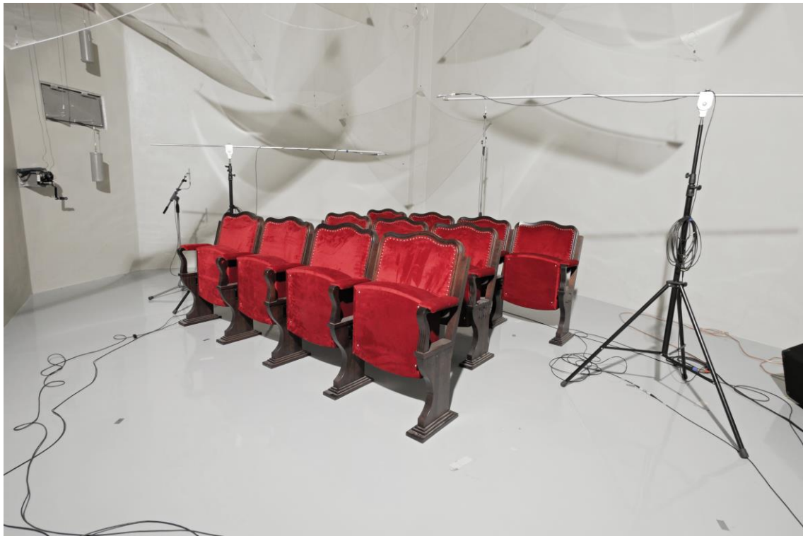
Obr. 3: Rozestavení nových sedadel při měření ekvivalentní pohltivé plochy
