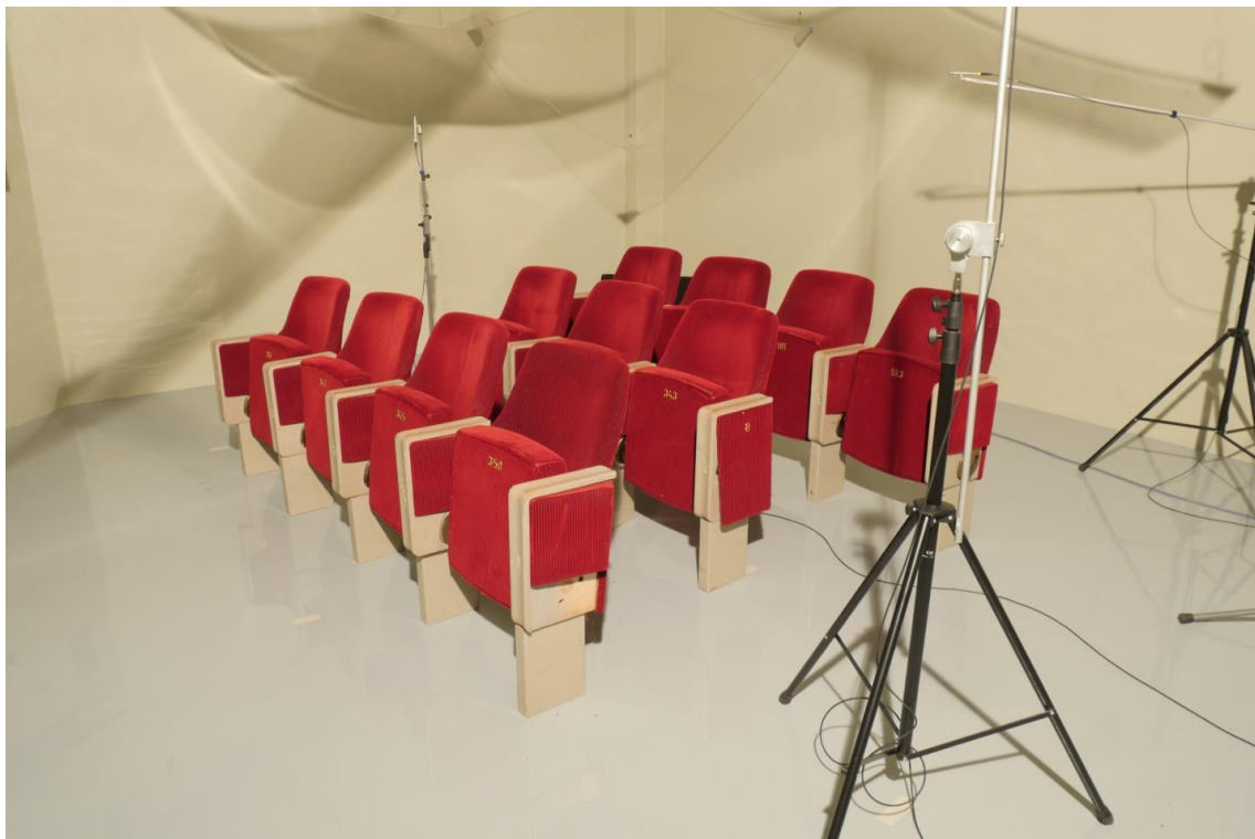
Obr. 4: Rozestavení původních sedadel při měření ekvivalentní pohltivé plochy (měřeno 18.5. 2017)
