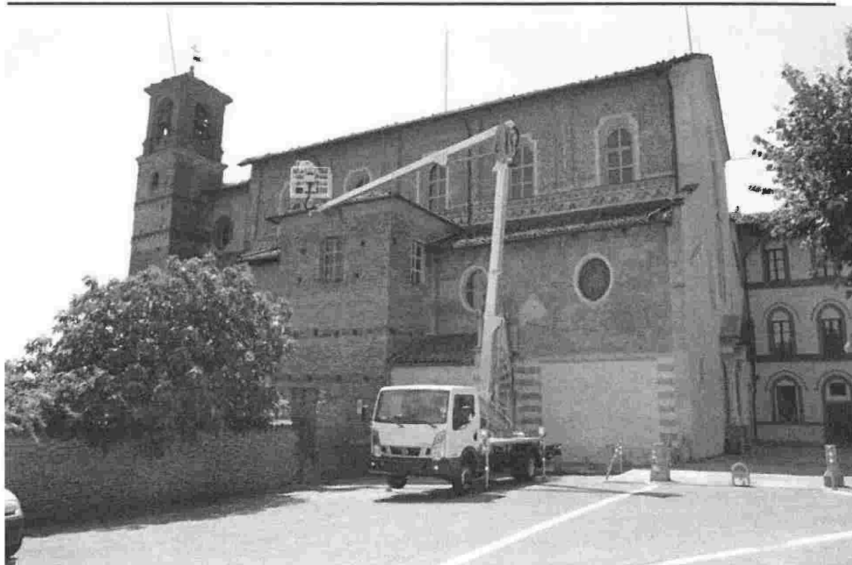
Obr. Teleskopická koncepce umožňuje práci s ramenem plošiny na silnici mimo průjezdní profil vozovky
