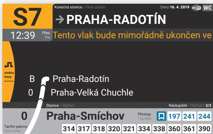
4. Základní obrazovka – vlak stojí ve stanici (Praha-Smíchov). Číslo linky je žlutě podbarveno a zobrazuje se informace o změně trasy.
