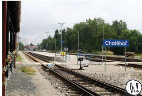
04.035 ▲ Poloostrovní nástupiště použitelné na regionálních tratích je alternativou k podchodu. V místě přecházení chybí výstražné zařízení s optickou a akustickou signalizací [zst. Chotěboř]. #nastupiste #poloostrovninastupiste #chotebor
