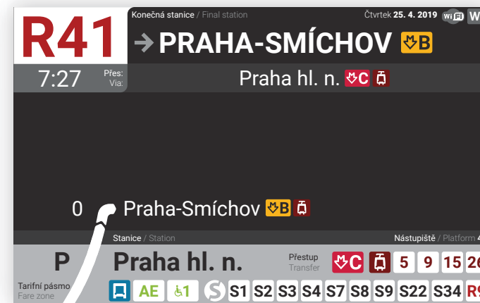
6. Základní obrazovka – vlak stojí ve stanici (Praha hl. n.). Pokud vlak stojí ve stanici delší dobu, může se střídát s přestupními obrazovkami.
