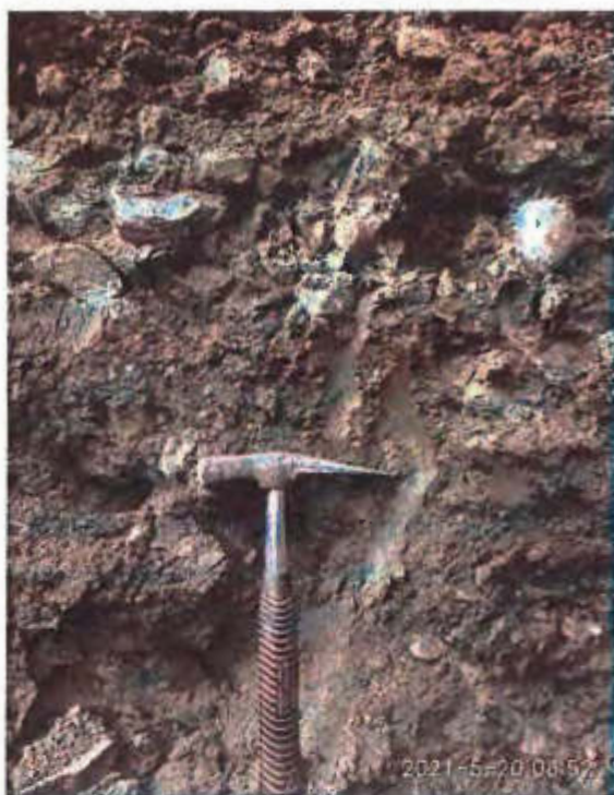
Obr. 4 – konstrukce vozovky a jílovitý štěrk
