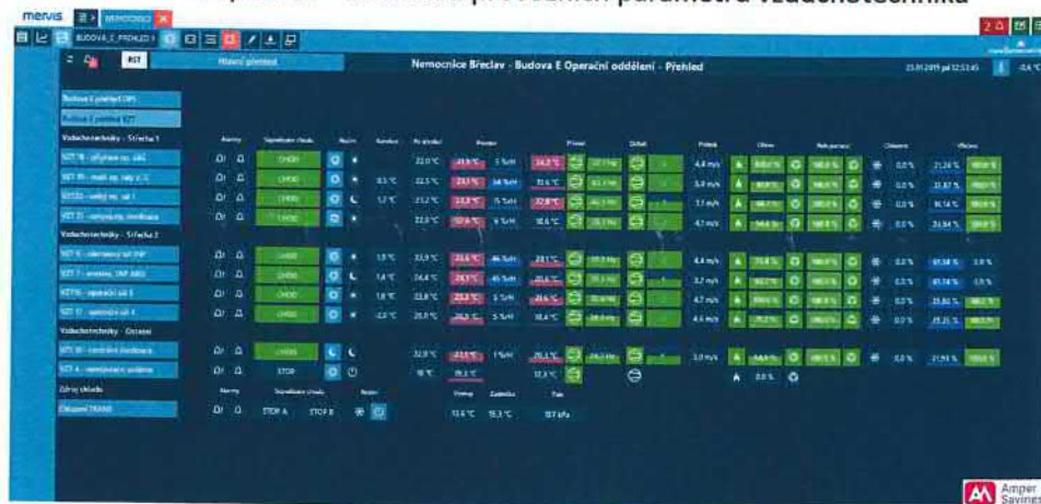
Obr. 5: webová aplikace – sledování provozních parametrů vzduchotechnika
