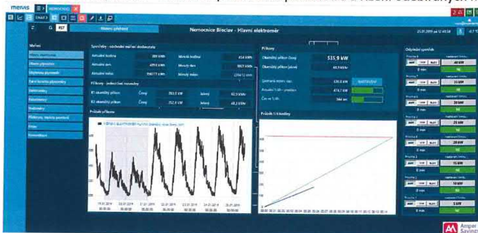
Obr. 4: webová aplikace – sledování provozních parametrů a řízení odebraných maxim
