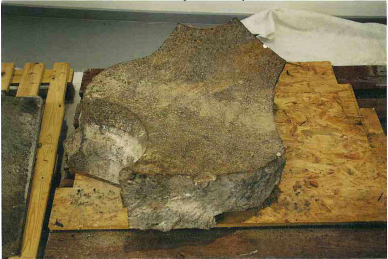
Sřepina pancéřového zvonu Rozměry přibližně 75 x 75 x 30 cm Hmotnost přibližně 500 kg
