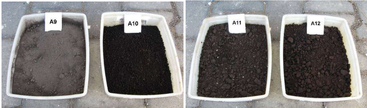
Příklady probíhajících modelových testů biodegradace kontaminovaných zemín ropnými látkami
