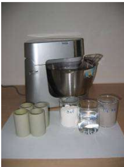
Aparatura pro modelové testy solidifikace / stabilizace a příklady stabilizované kontaminované zeminy z válcových forem
