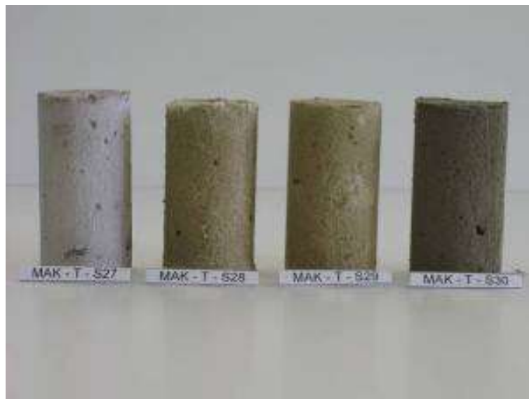
Aparatura pro modelové testy solidifikace / stabilizace a příklady stabilizované kontaminované zeminy z válcových forem
