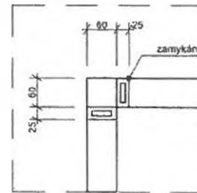
detail napojení lavic v rohu květináče 1:10
