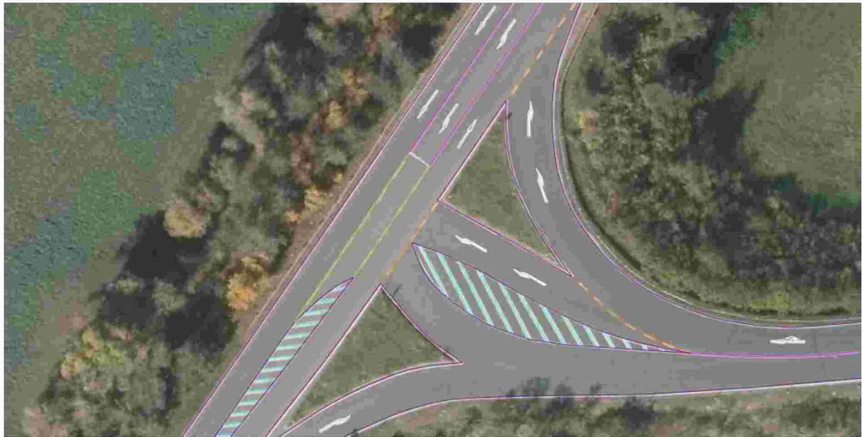
Obr. Ukázka vodorovného dopravního značení
