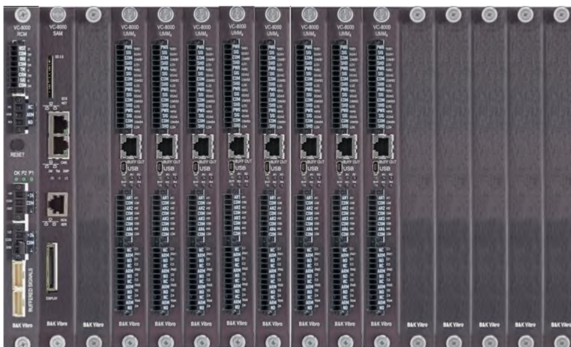
Obr. 1 - Konfigurace monitoru na obrázku odpovídá nabízenému řešení (1x RCM, 1x eSAM, 8x UMM).
