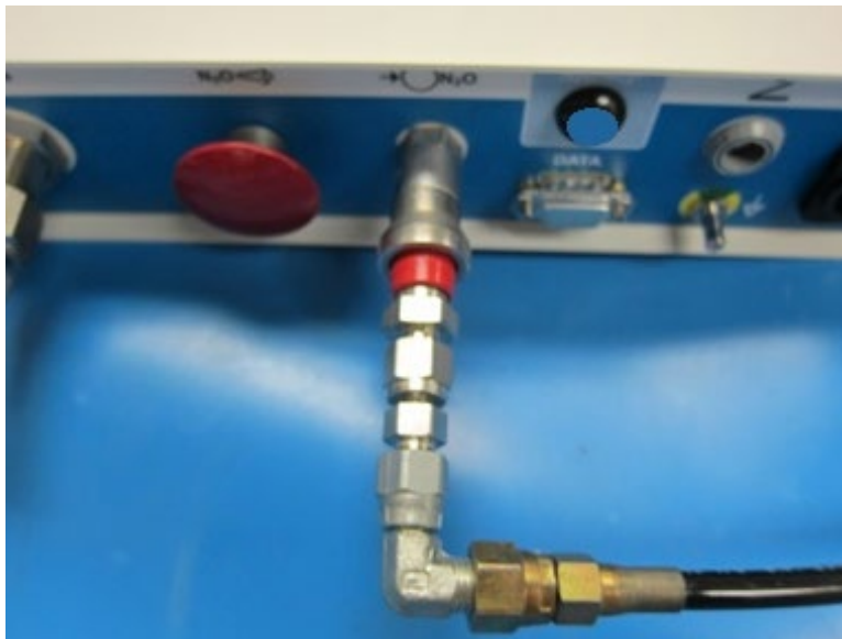
Obrázek 4: Připojení vstupu N 2 O
