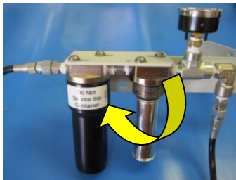
Obrázek 24: Odpojení kazety vysoušecího filtru
