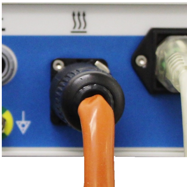
Obrázek 9: Připojení kabelu ohřívacího pásu do zásuvky
