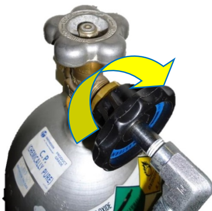
Obrázek 5: Připojení černého knoflíku k závitovému konektoru
