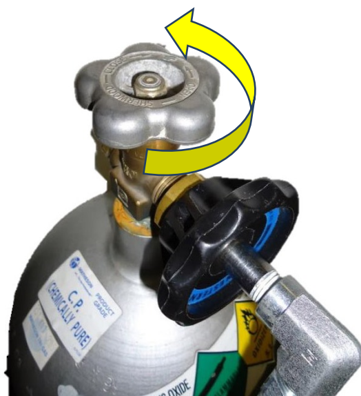
Obrázek 6: Otevření ventilu otáčením proti směru hodinových ručiček
