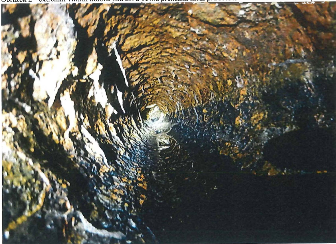
Obrázek 2 - extrémní vnitřní koroze potrubí a pevná překážka mezi přírubami ventilů do vsakovacího pole
