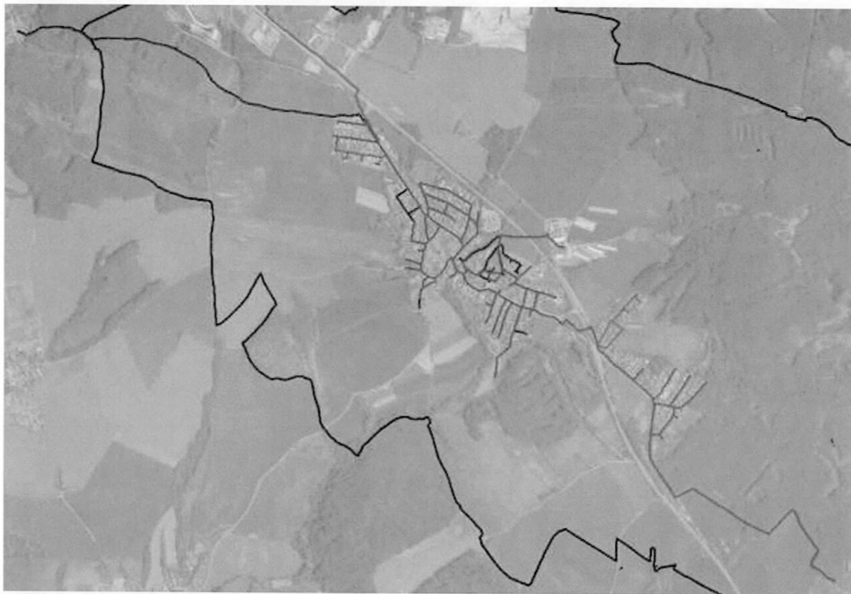
Obr. 2: Chotíkov, vodovodní infrastruktura. (Zelená - Data v přesnosti umožňující přepracování do DTM. Červená – Nepřesná data nebo data bez určení původu, rozsah vodovodní sítě určené k zaměření. Šedá – vodovodní infrastruktura mimo vlastnictví obce, do projektu není zahrnuta. Hnědá – hranice obce.)
