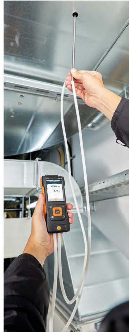
Při měření objemového průtoku při vysokých rychlostech proudění nebo v případě silně znečištěného proudění doporučujeme testo 440 dP a Pitotovu trubici.
