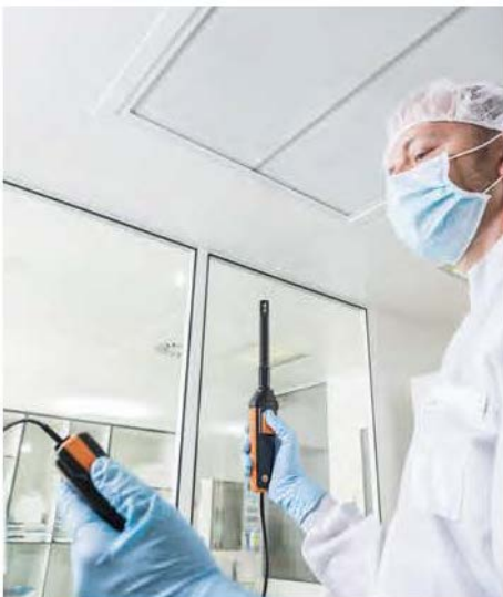
Musíte také měřit v prostorech, kde nefunguje Bluetooth? Žádný problém: jednoduše nasunete hlavici sondy z rukojeti Bluetooth na kabelovou rukojeť a hotovo.
