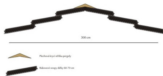
Pohled z boku na střechu rákosové pergoly schéma překryvu rákosové krytiny
