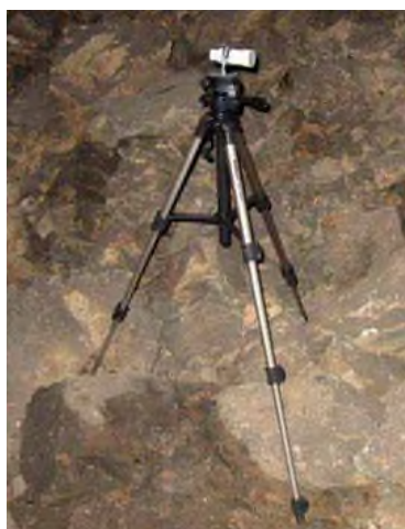
Obr. 6 (vlevo) Umístění teplotních čidel v interiéru jeskyně – jedna výška. Obr. 7 (vpravo) Umístění teplotních čidel v interiéru jeskyně – vertikální profil.
