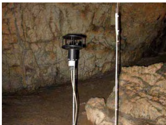
Obr. 18 Ukázka umístění 2D sonického anemometru v Kateřinské jeskyni.
