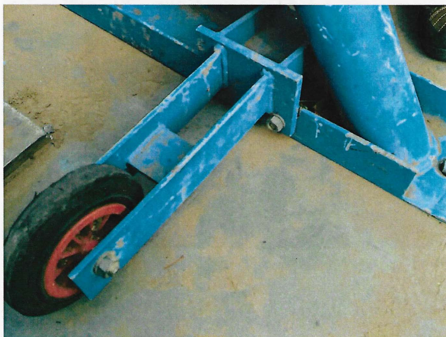
Detail konzoly a pojezdového kola jeřábku.
