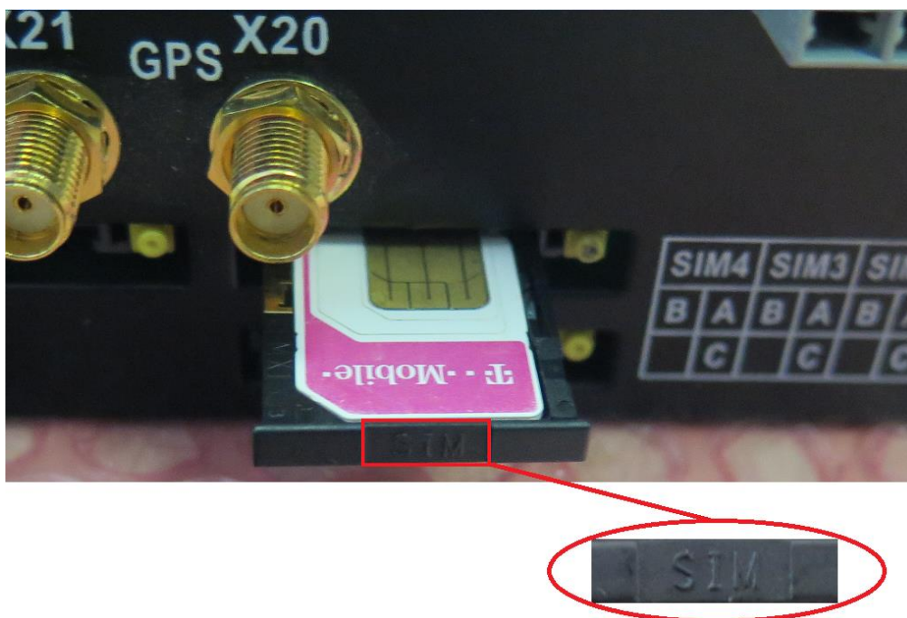
Obr. 3 – Správné vložení šuplíku se SIM kartou
