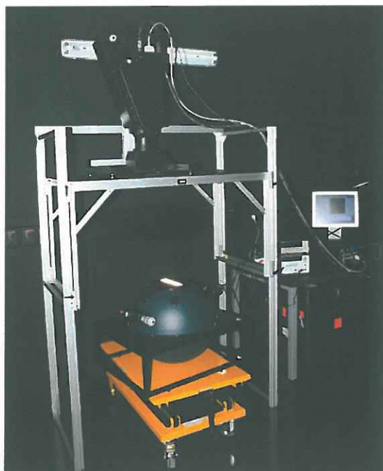
Obr. 4: Ukázka laboratorního určování radiometrických kalibračních koeficientů senzoru SASI-600 na CzechGlobe
