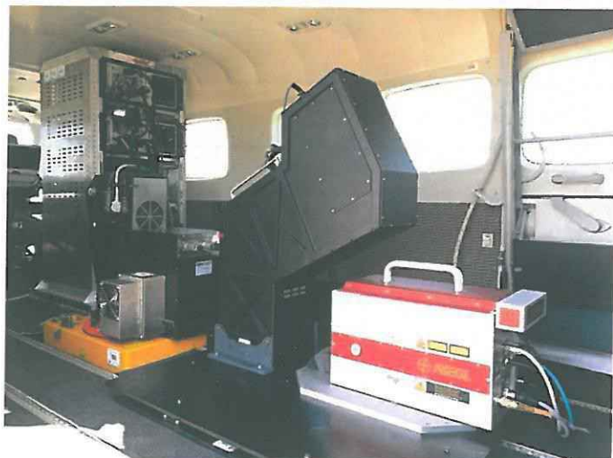
Obr. 1: FLIS –Hyperspektrální senzory CASI-1500, SASI-600, TASI-600 včetně laserového skeneru Riegl LMS-Q780 instalované v kabině letadla.
