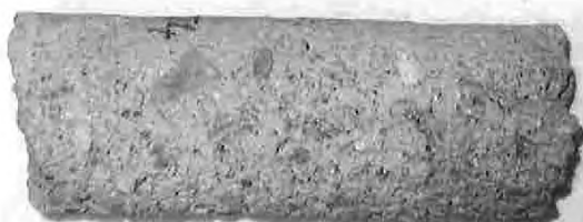
Obr. 2.: Vývrtý z betonu nosné konstrukce po dodání do laboratoře - první skupina
