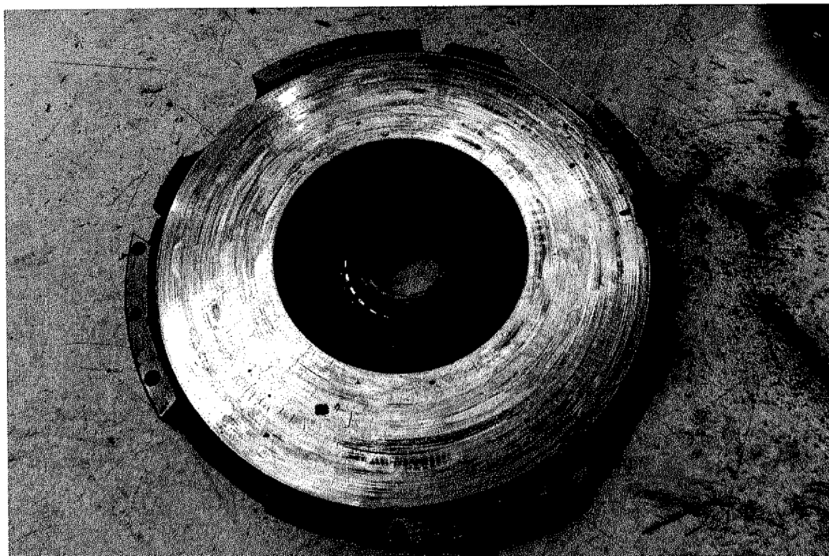
Poškozený přítlačný talíř víka spojky včetně vypínacího ložiska
