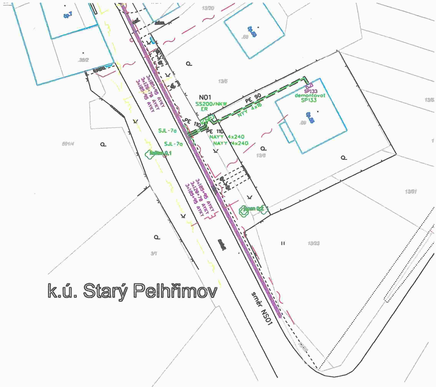
Situace vč.stávajících podzemních sítí ( M 1:500) :
