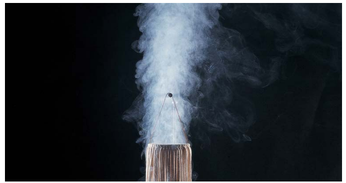
Testovací požár 3: Žhnoucí doutnající požár (bavlna)
