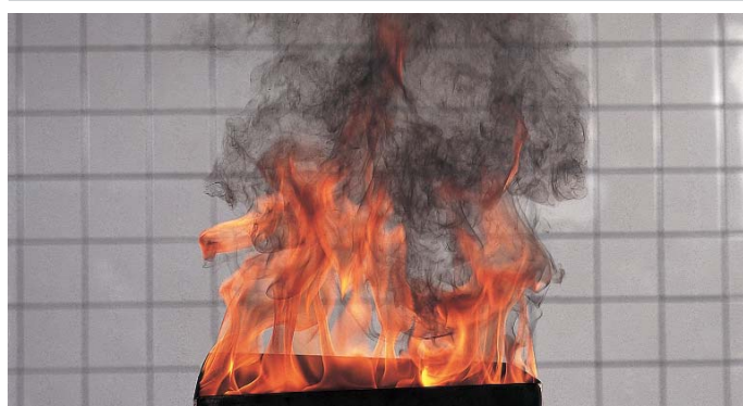
Testovací požár 5: Požár kapalin (n-heptan)
