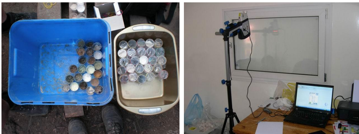
Obrázek 2 – Vzorčky odpadů k analýze metodou XRF na přístroji Innov X-Delta
