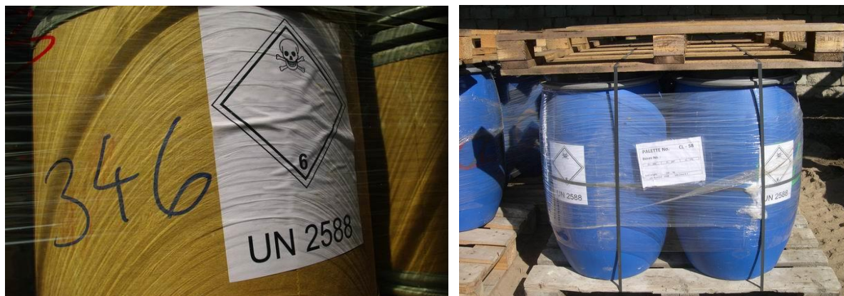
Obrázek 4 - Označování jednotlivých obalů a obalových souborů dle ADR
