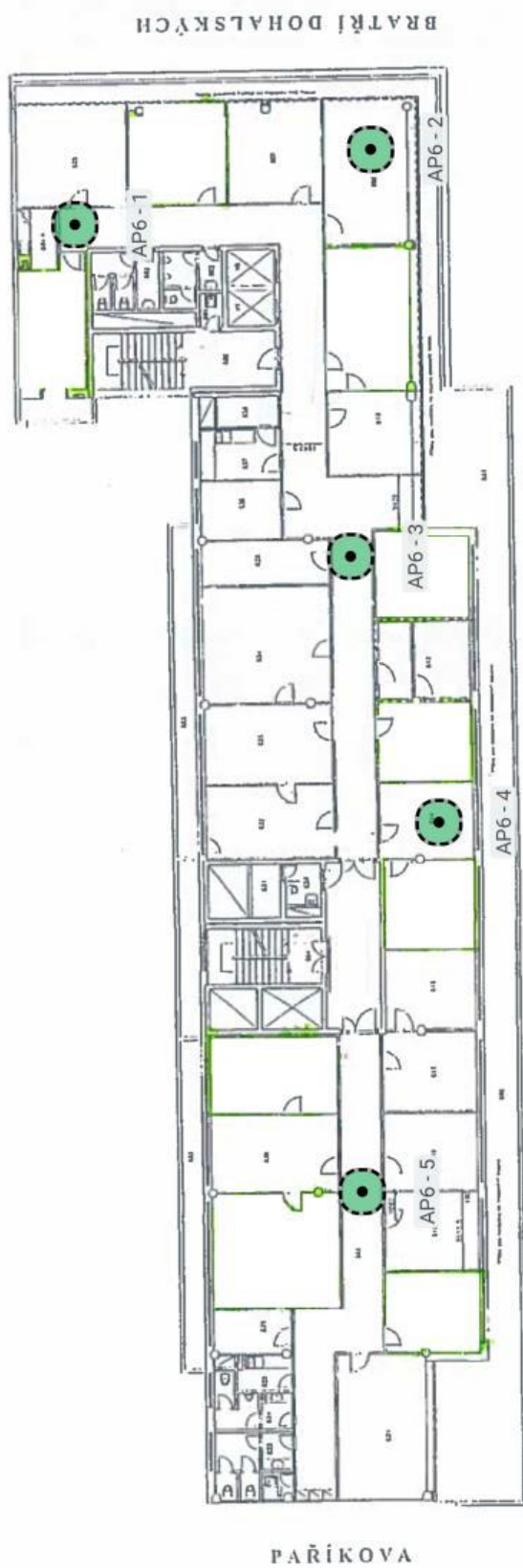
Obrázek 6: Navrhované rozmístění AP v 6. patře
