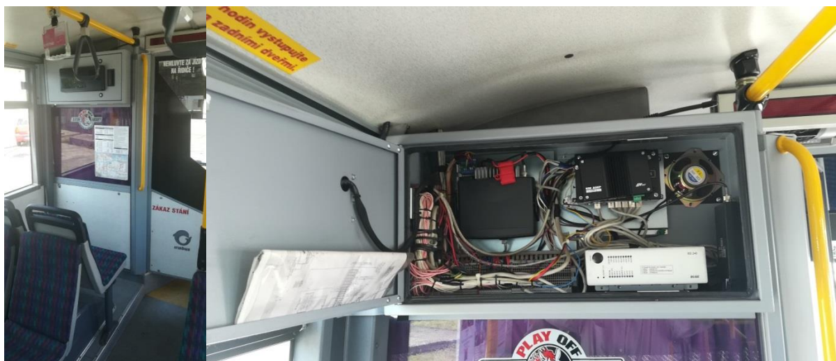
Obr. 8 umístění radiostanice ve vozidlech KAROSA B951 (v prostoru vedle řidiče)
