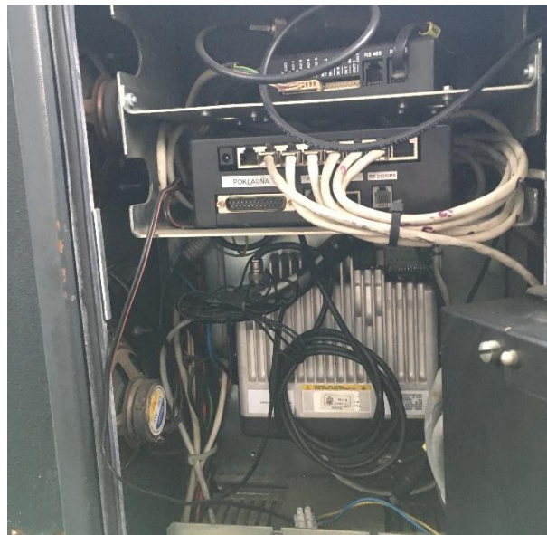
Obr. 4 umístění radiostanice ve vozidlech 21Tr (v prostoru schránky vedle řidiče)
