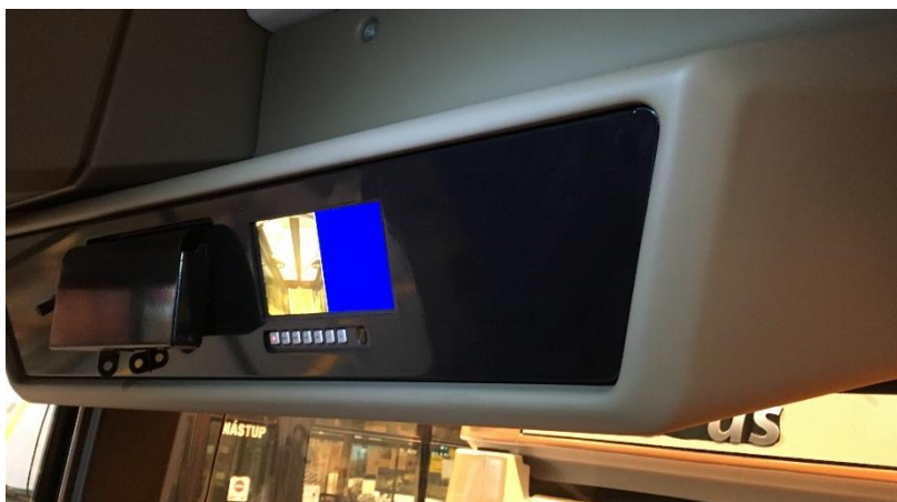
Obr. 5 umístění stávající radiostanice ve vozidlech URBANWAY (v prostoru nad řidičem)
