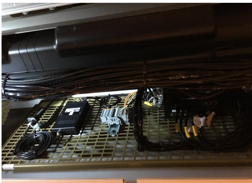
Obr. 6 nové umístění radiostanice ve vozidlech URBANWAY (v prostoru za prvními dveřmi, společně s palubním počítačem)
