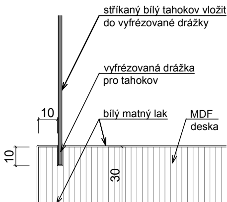
DETAIL 10 - osazení tahokovu, M 1:2
