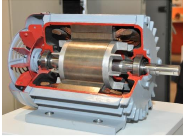
Fig. 8 – Ilustrativní ukázka podélného řezu elektromotorem
