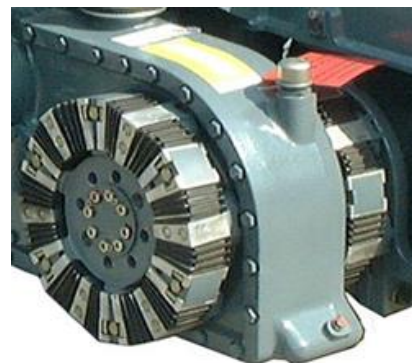
Fig. 4 – Hnací kloubový hřídel s dvojicí BSI kloubů
