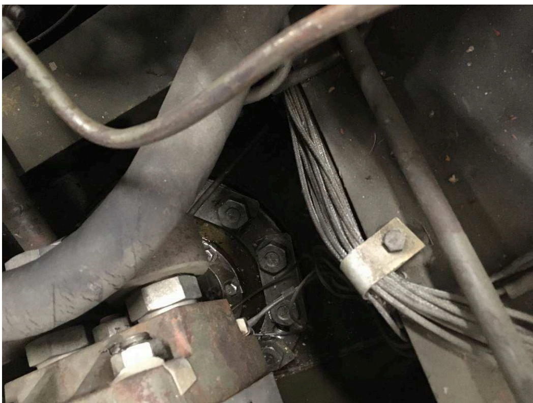
Foto č. 6 – Přetěsnění 2 ks pracovních válců.
