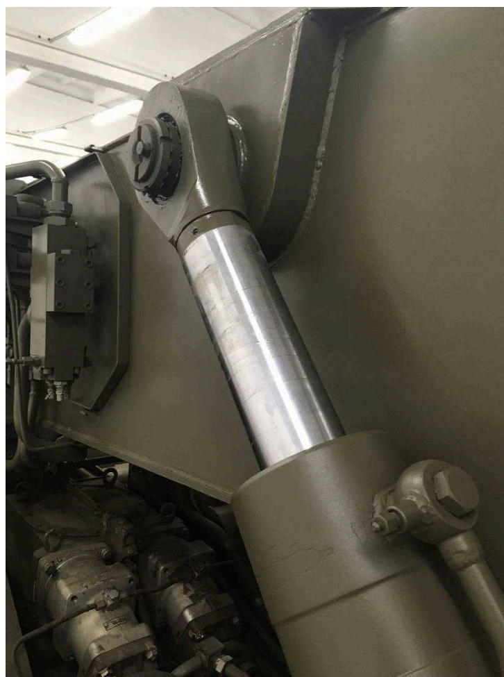
Foto č. 6 – Přetěsnění 2 ks pracovních válců.
