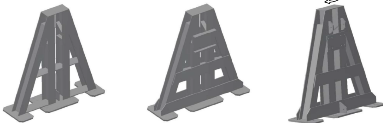
Obr. 6: Přední sloup – postup sestavení.
