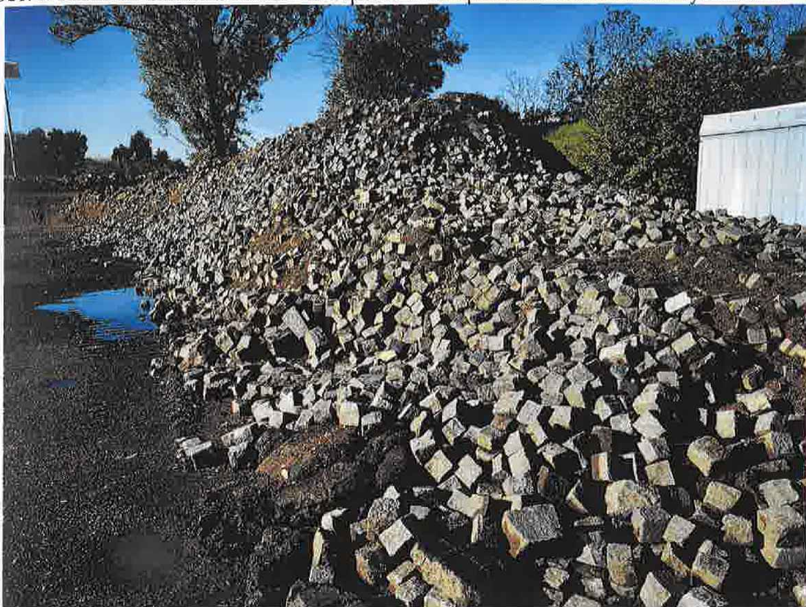
Obr. č. 2 Příklady DK s poškozením hlavy DK. Patrná i „podjetost“ některých kusů DK
