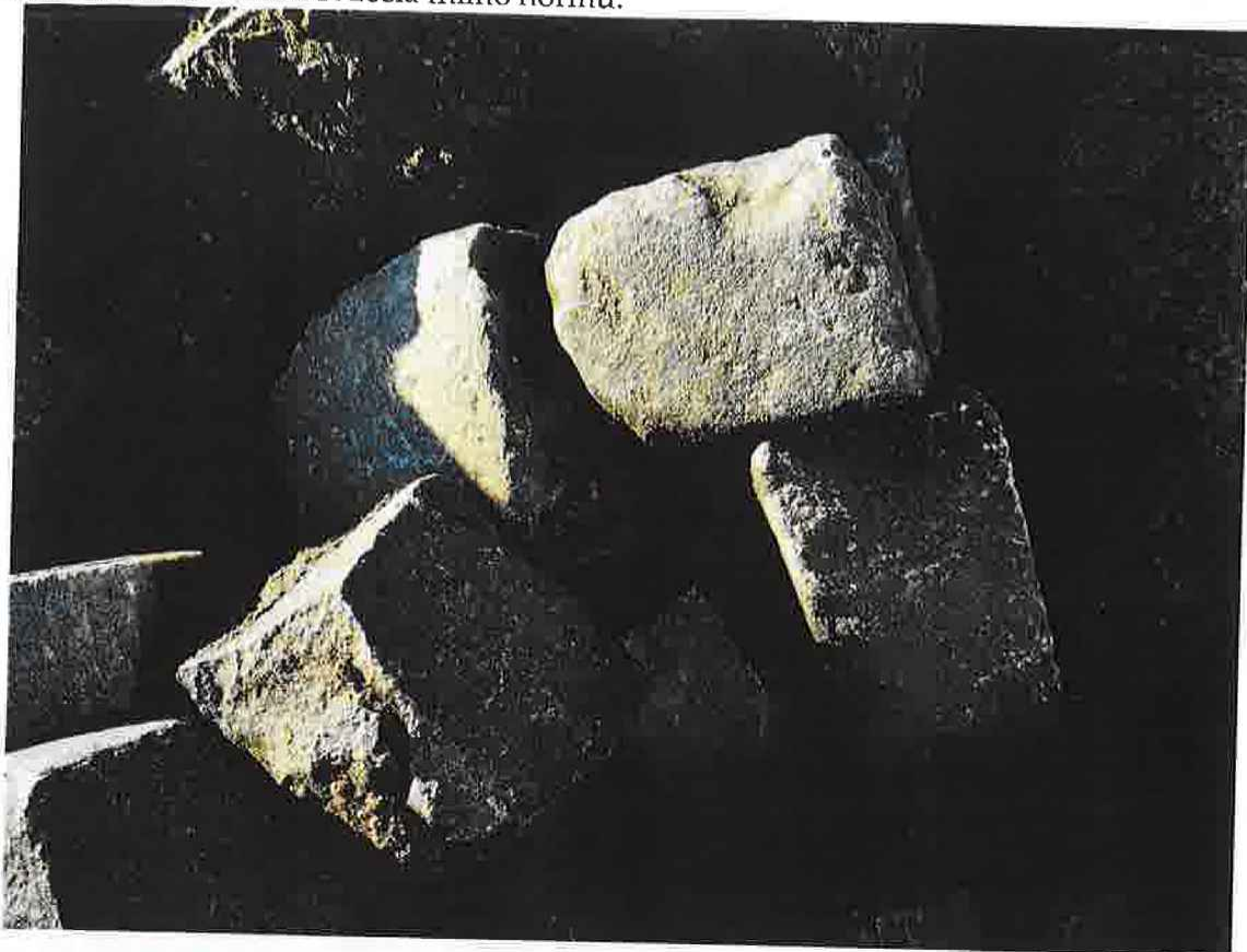
Obr. č. 3 Pohled na část DK s patrným přilepem šterku. Patrná i rozměrová a materiálová různorodost. Některé DK zcela mimo normu.
