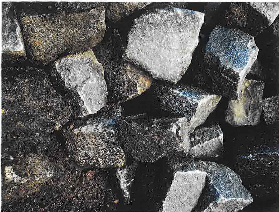
Obr. č. 4 Pohled na část DK s patrným přilepem šterku a relikty asfaltu. Patrná materiálová různorodost a DK rozměrově zcela mimo normu. Patrná i „podjetost“ některých kusů DK.
