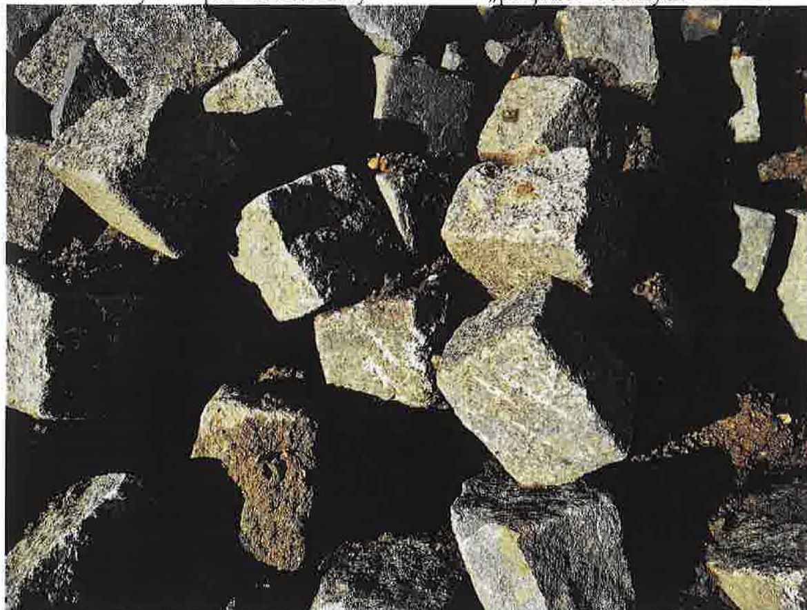
Obr. č. 2 Příklady DK s poškozením hlavy DK. Patrná i „podjetost“ některých kusů DK
