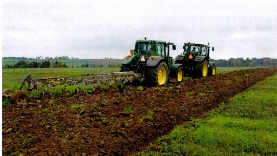
Obrázek 3: Fotografie měření tahového odporu pluhu PHX 6-30
