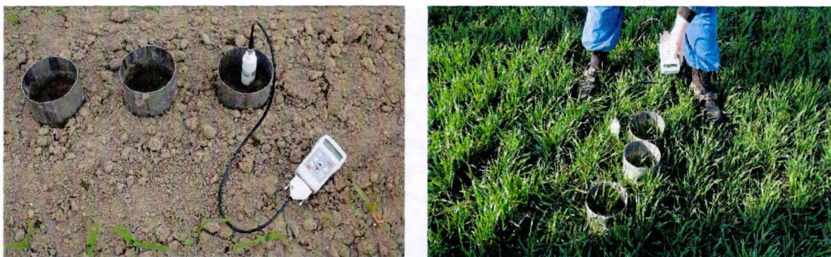
Obrázek 1 a 2: Ukázka měření infiltračních schopností pomocí kruhového infiltrometru – vlevo u silážní kukuřice (2018) a vpravo – u pšenice ozimé (2019/2020)
