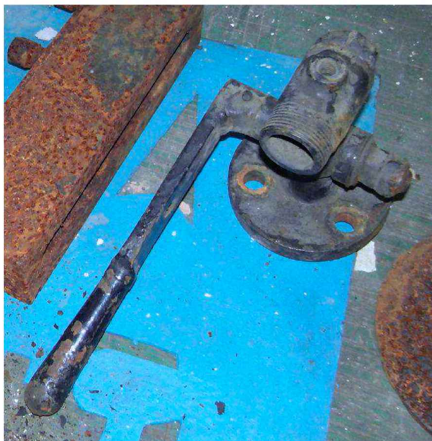
Obr. 25 Zachovaný horní kohout původního vodoznaku.
