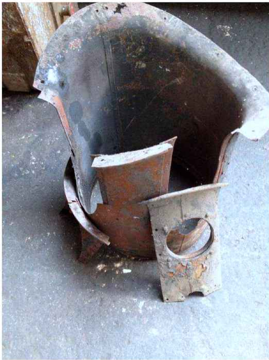
Obr. 62 - 63 Plechový obal parojemu je kompletní a bude znovu použit (vpravo). Z komínu lokomotivy se použije jen litinový fundament.
