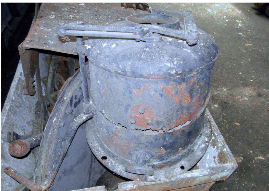
Obr. 61 Rozpadlý písečník. V násypném otvoru chybí poklička.
