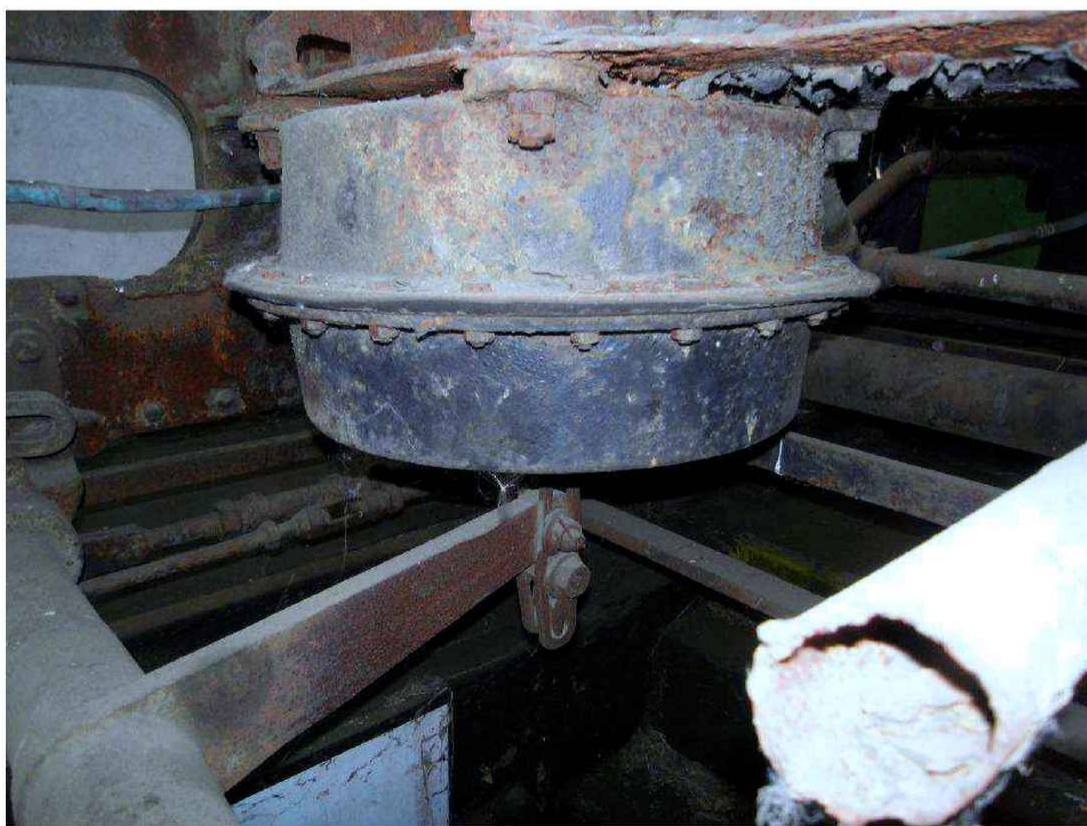
Obr. 46 Brzdový válec upevněný na rámové výztuže.
