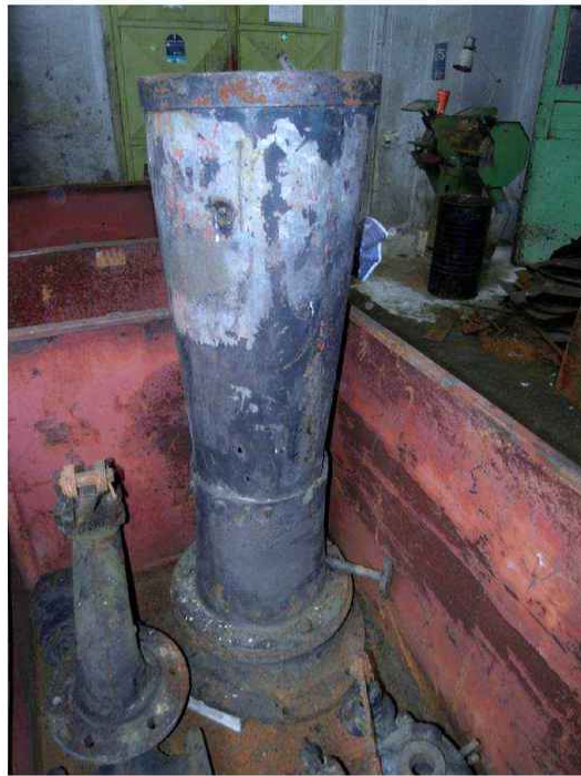
Obr. 62 - 63 Plechový obal parojemu je kompletní a bude znovu použit (vpravo). Z komínu lokomotivy se použije jen litinový fundament.
