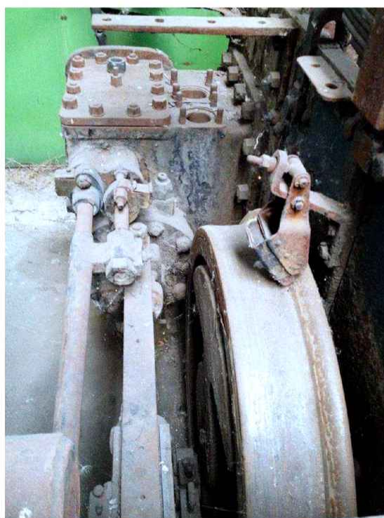
Obr. 41 - 42 Chybějící spodní díl ložiska hnací nápravy na L straně (vlevo) a zachovaná mazací patrona okolku spřažené nápravy (vpravo).
