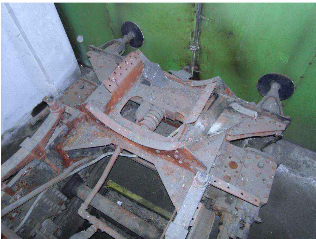
Obr. 44 Mezi dýmniční podpěrou je dobře vidět nekompletní a provizorně opravené odpružení tažného háku. Patrné je pokřivení nárazníků.
