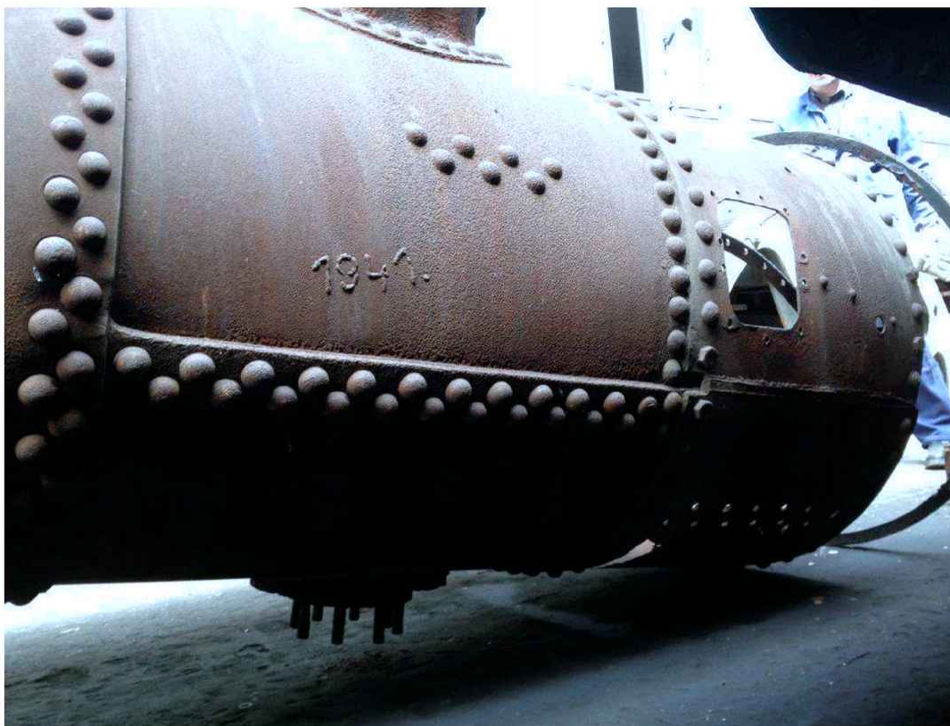
Obr. 22 Letopočet 1941, nanesený elektrodou na těleso kotle, koresponduje se lhůtou hlavní opravy lokomotivy. Tehdy zřejmě došlo k výměně stěn skříňového kotle.
