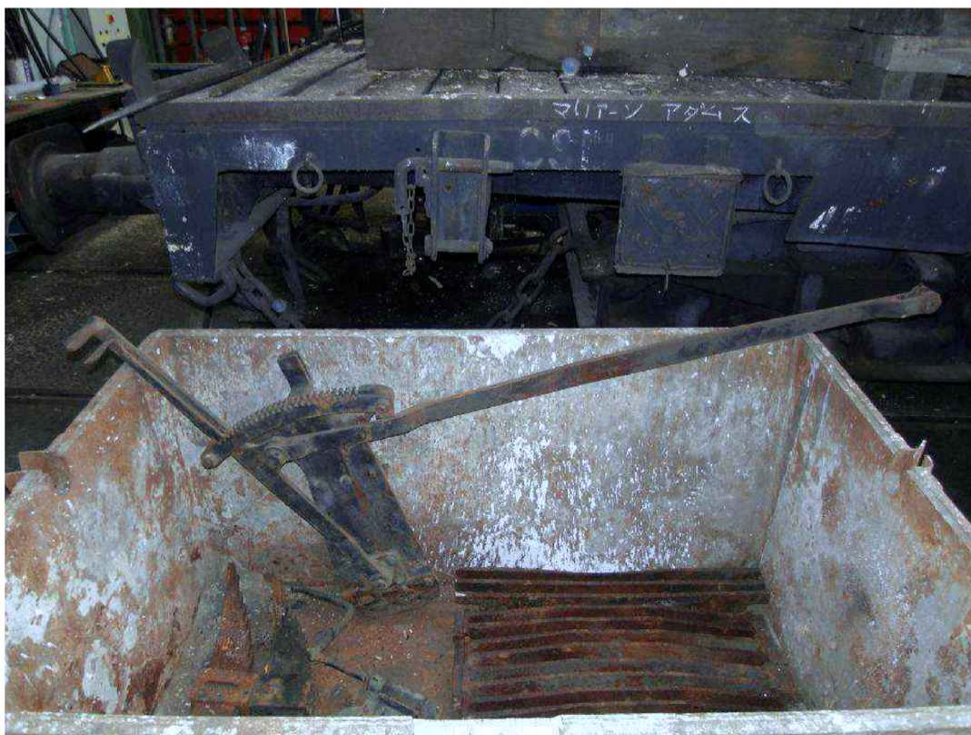
Obr. 31 Stojan reverzní páky a roštnice.
