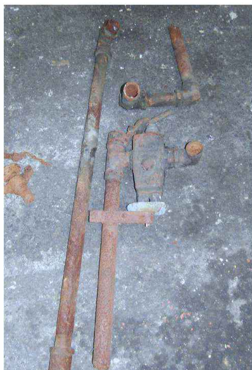
Obr. 47 - 48 Podstatné součásti ssací brzdy jsou zachovány. Vlevo ejektor s tlumičem, vpravo odbrzdňovací klapka, odvodňovač se zpětnou klapkou a torzo potrubí.
