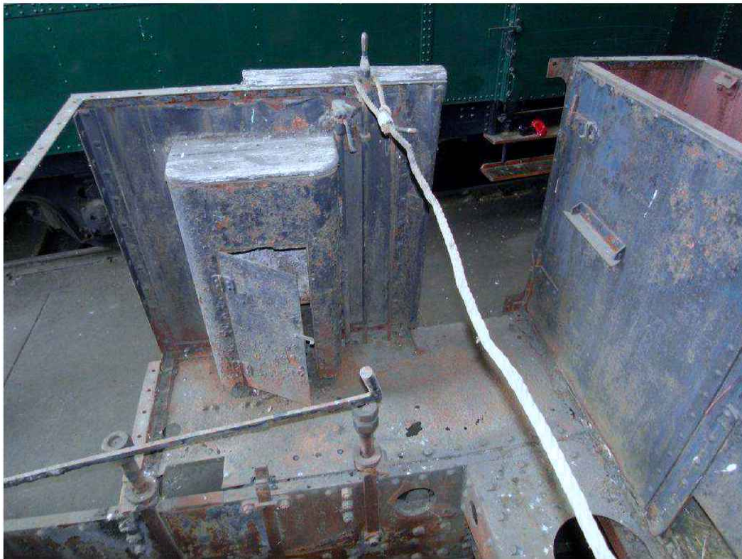
Obr. 54 Pravá strana stanoviště. Zde je korozní napadení plechové podlahy již natolik pokročilé, že ji bude třeba vyměnit.
