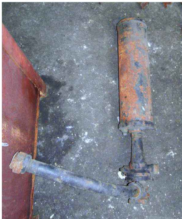
Obr. 47 - 48 Podstatné součásti ssací brzdy jsou zachovány. Vlevo ejektor s tlumičem, vpravo odbrzdňovací klapka, odvodňovač se zpětnou klapkou a torzo potrubí.
