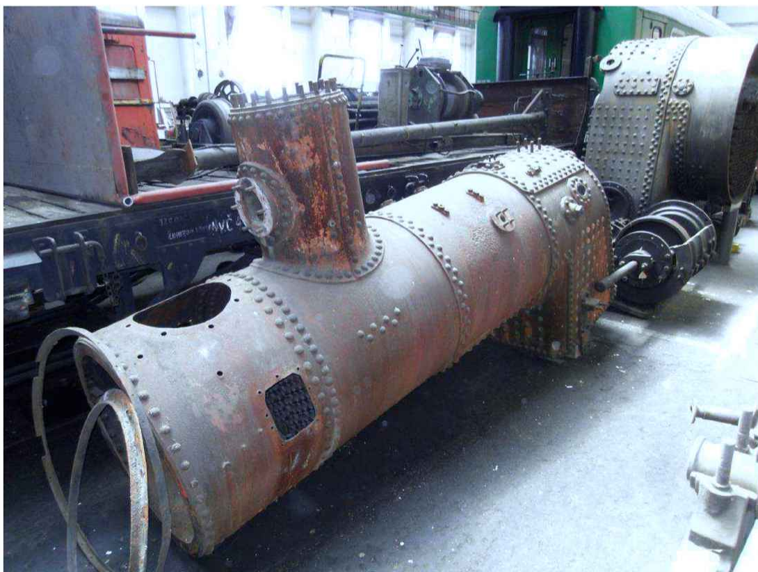
Obr. 15 – 16 Celkový pohled na odstrojené torzo lokomotivy (nahore) a kotel (dole).
