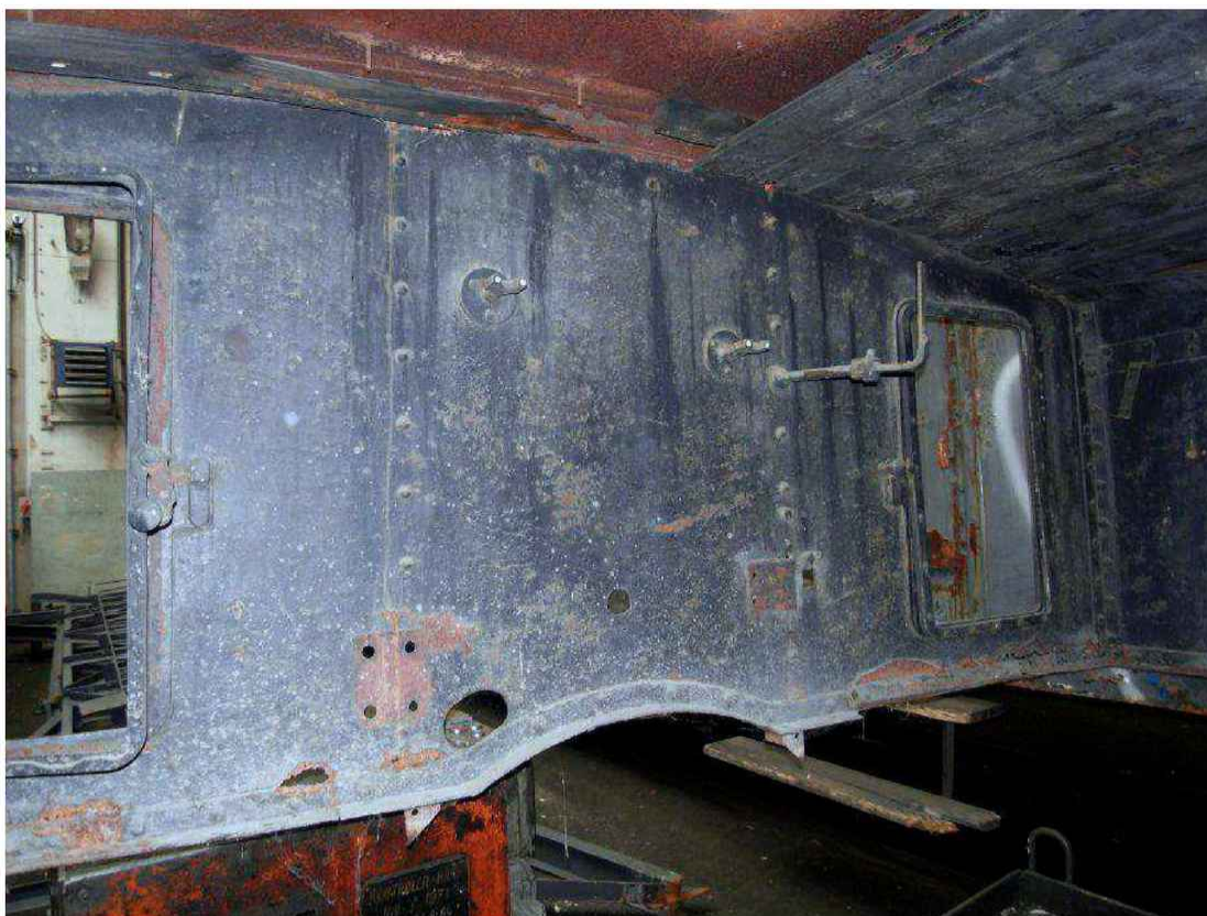
Obr. 60 Přední stěna budky. Dobře viditelný je trn pro lampu k osvětlování přístrojů a dva držáky manometrů. Poblíže okna byl přímo na stěnu upevněn vakuometr brzdy.
