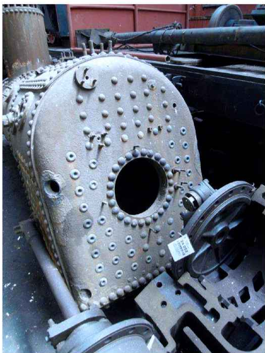
Obr. 17 – 18 Na dveřnici kotle chybějí veškeré armatury. V kotli jsou zaválcovány všechny žárnice opatřené v topeništi pertlováním.
