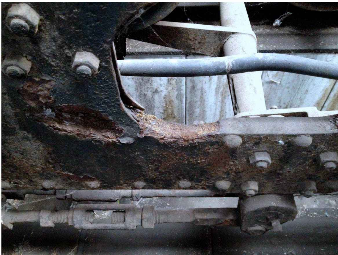
Obr. 38 – 39 Korozní poškození rámu.
