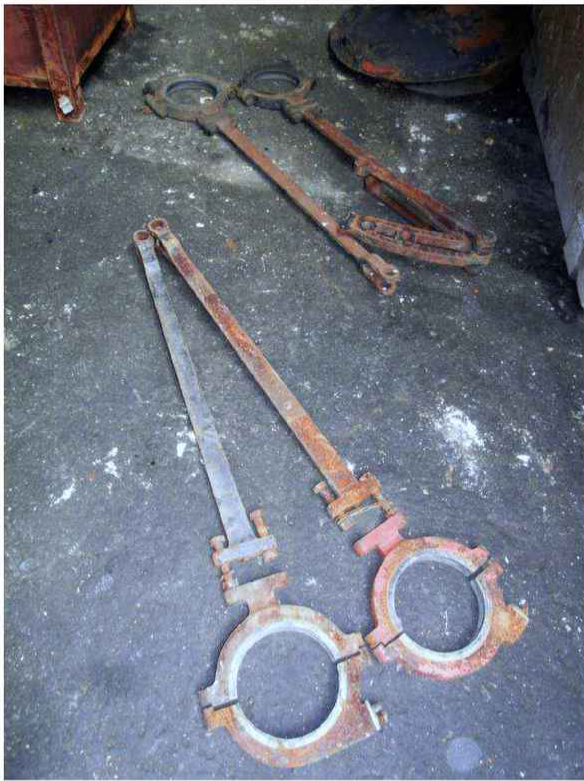
Obr. 34 - 35 Rozvodové a hnací tyčové je kompletní a jeho části jsou v prakticky stejném stavu. Zde jako příklad výstředníkové tyče (vlevo) a ojnice (vpravo).
