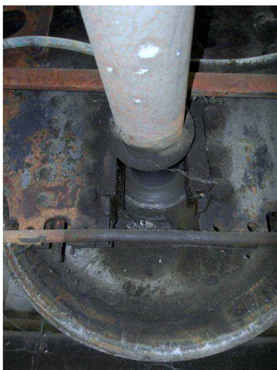
Obr. 41 - 42 Chybějící spodní díl ložiska hnací nápravy na L straně (vlevo) a zachovaná mazací patrona okolku spřažené nápravy (vpravo).
