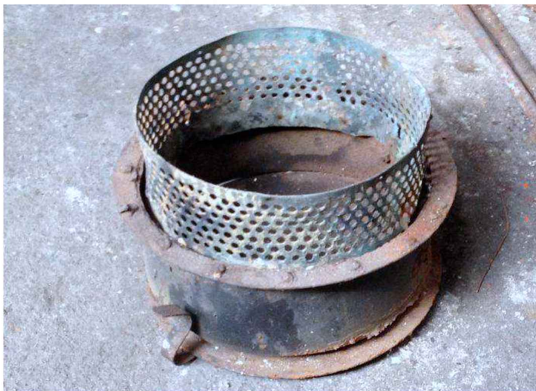
Obr. 51 Plnicí hrdlo P vodní vany s torzem síta.
