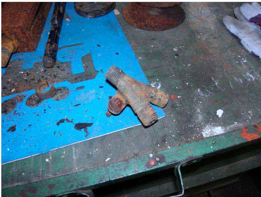
Obr. 26 Zachovaná původní rozdvojka mazacího vedení, podle které se vyrobí druhá, chybějící.
