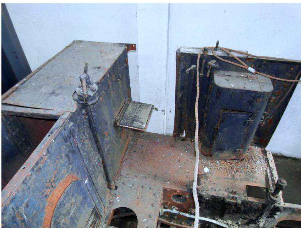
Obr. 53 Levá strana stanoviště s nářad'ovou skříňkou. Na stěně uhláku sklopená sedačka.
