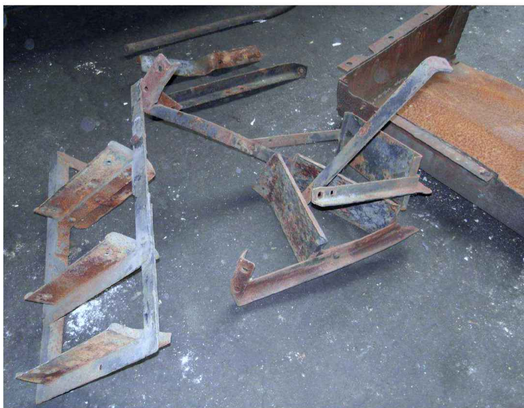
Obr. 57 K původně dvoustupňovým schůdkům stanoviště byl v poválečné době přišroubován třetí stupeň usnadňující čtě přístup na lokomotivu. Ten se odstraní.
