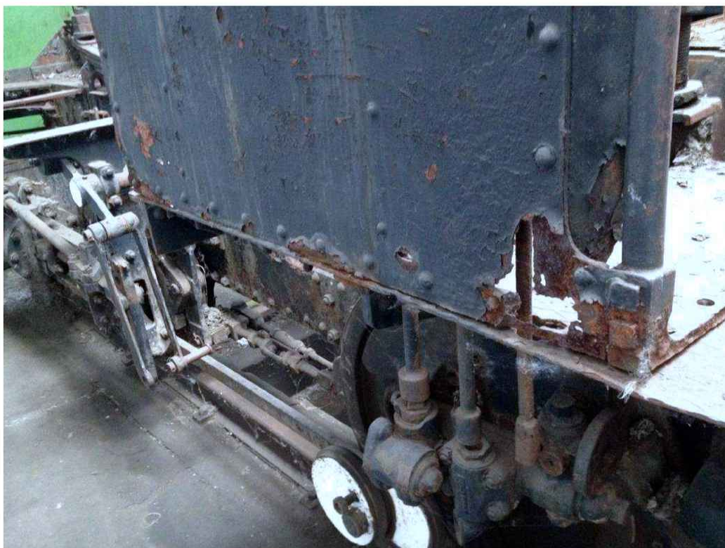
Obr. 52 Nejhorší korozní napadení budky je pochopitelně ve spodní části. Tyto díly bude nutné vyspravit vevařenými záplatami.
