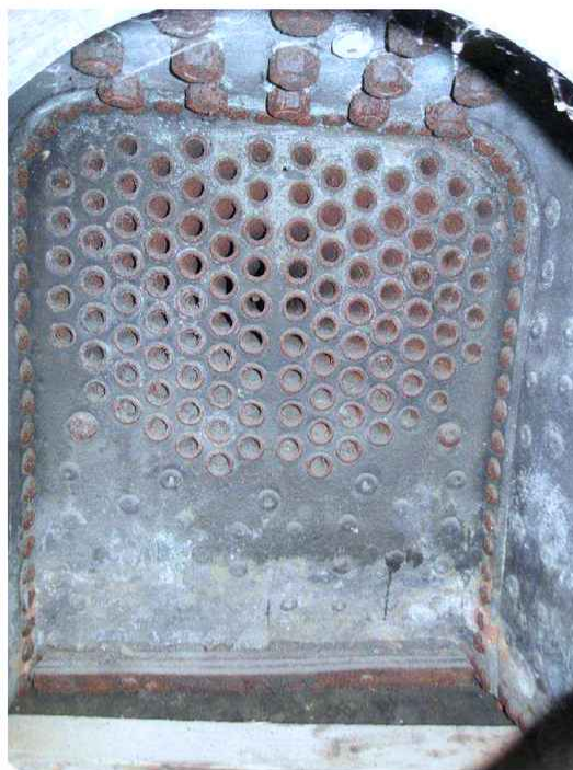
Obr. 17 – 18 Na dveřnici kotle chybějí veškeré armatury. V kotli jsou zaválcovány všechny žárnice opatřené v topeništi pertlováním.
