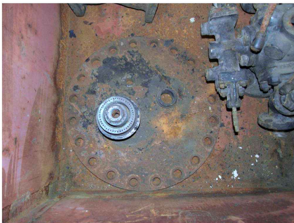
Obr. 23 Víko parojemu a stav dochování pojistných ventilů – jeden zcela chybí, z druhého zůstalo jen torzo.
