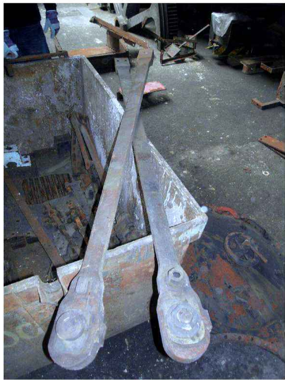
Obr. 34 - 35 Rozvodové a hnací tyčové je kompletní a jeho části jsou v prakticky stejném stavu. Zde jako příklad výstředníkové tyče (vlevo) a ojnice (vpravo).
