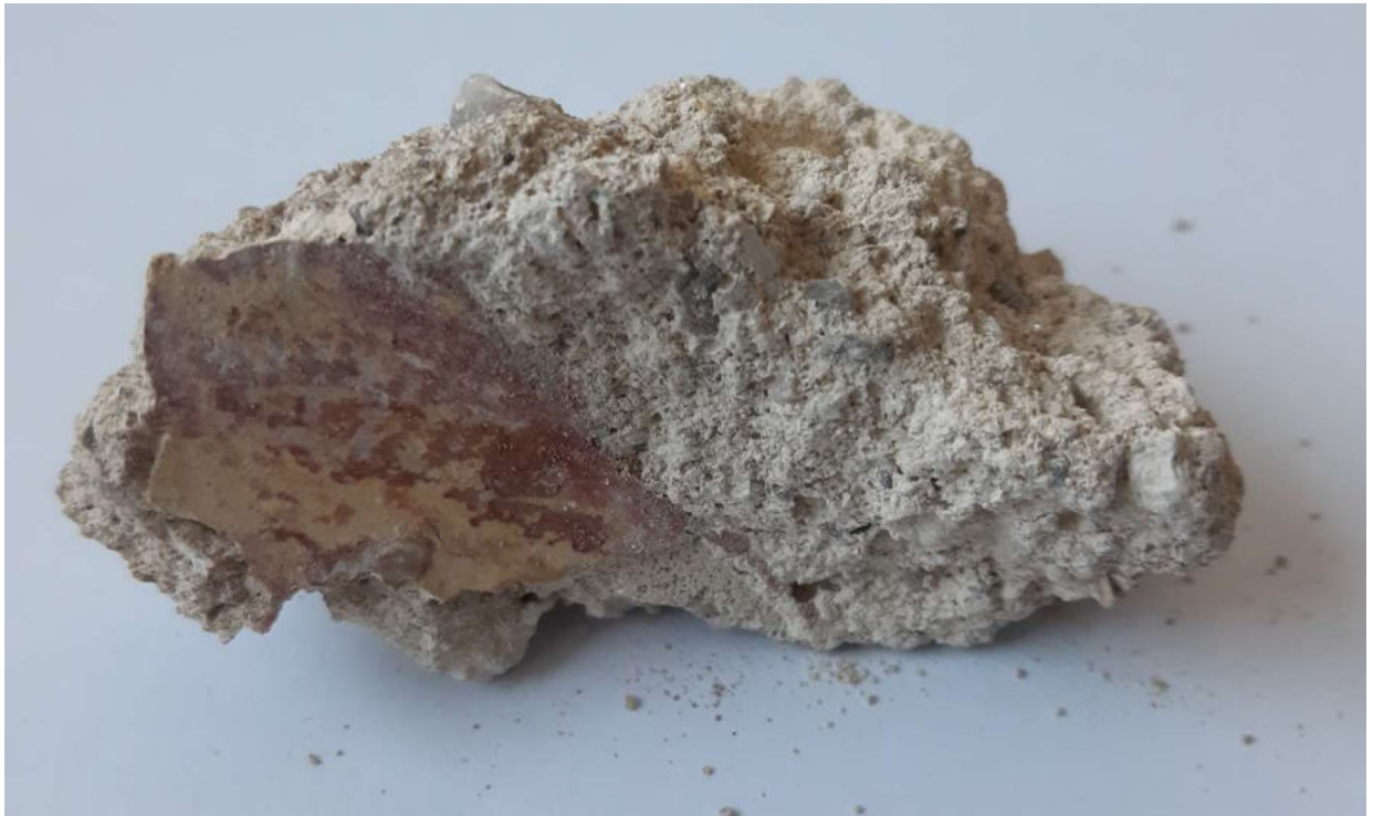
Maltovina zazdívký a barevné vrstvy odtržené od porty Sedlo porty vpravo
