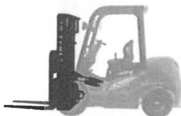
Nové uchycení zdv.rámu s delší vzdáleností. Zvyšuje životnost.
