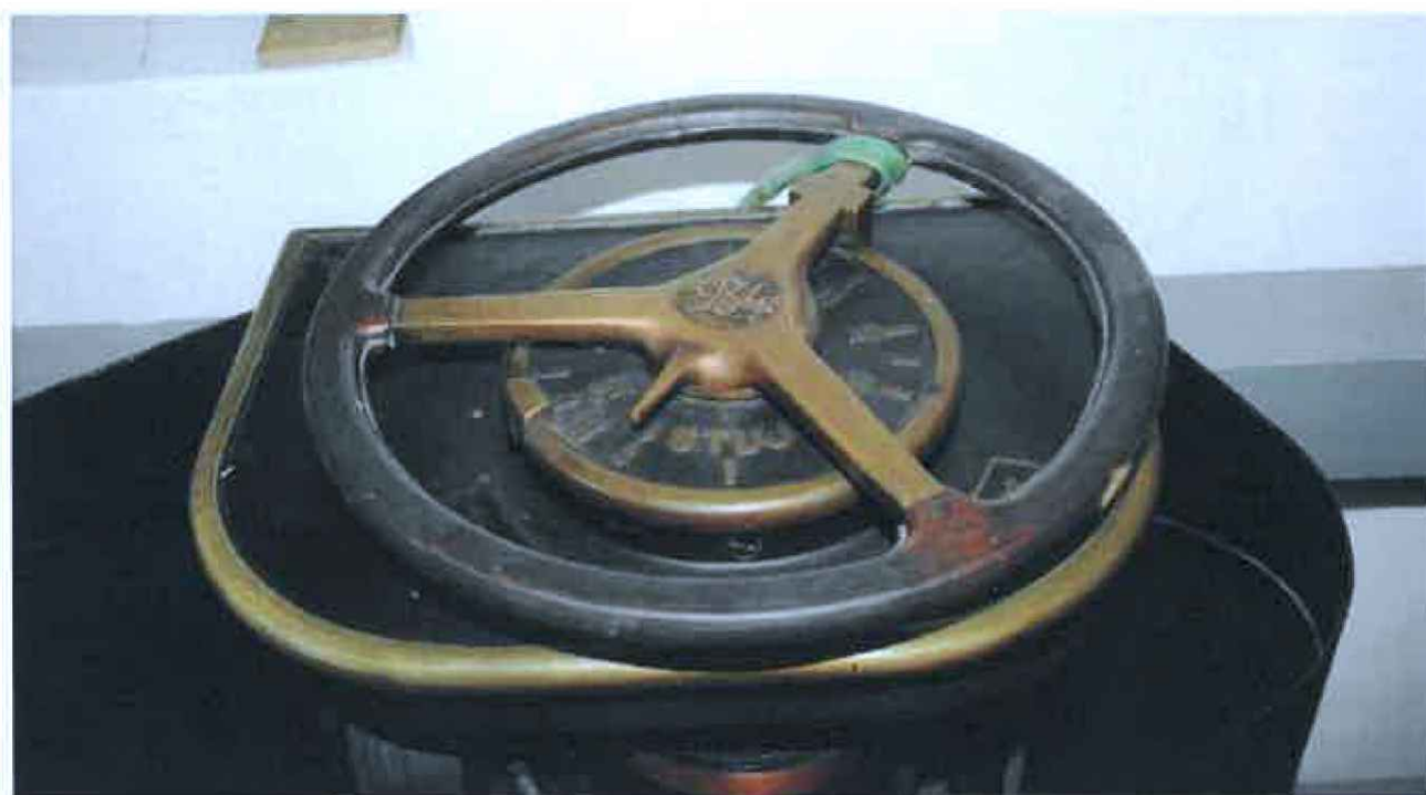
inv. č. 934/a,b kontrolér Křížík č. 13 s ovládacím volantem
