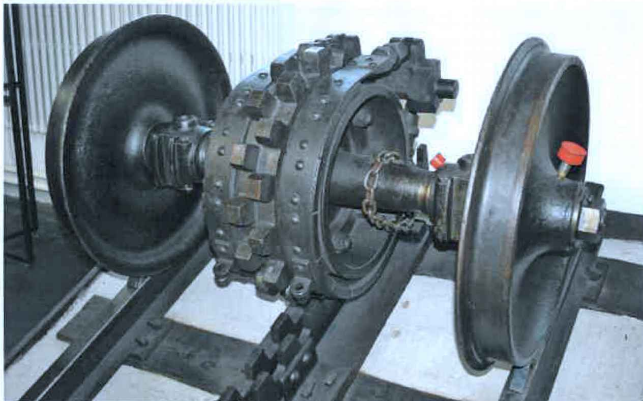
inv. č. 20082 dvojkolí z původního vozu lanové dráhy na Petřín
