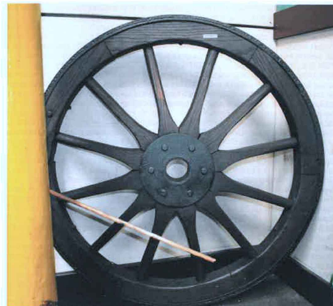
inv. č. 57852 loukotové kolo koněspřežného montážního vozu EP pro jízdu ve žlábkové koleji
