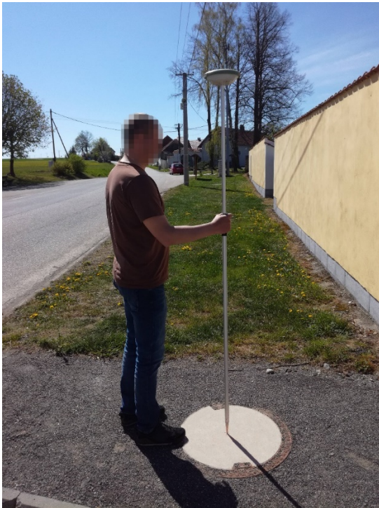
Obr. 4: Ukázka zaměření SVB technologií GNSS
