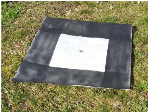
Obr. 2. Rozměry a způsob signalizace bodu geotextilií
