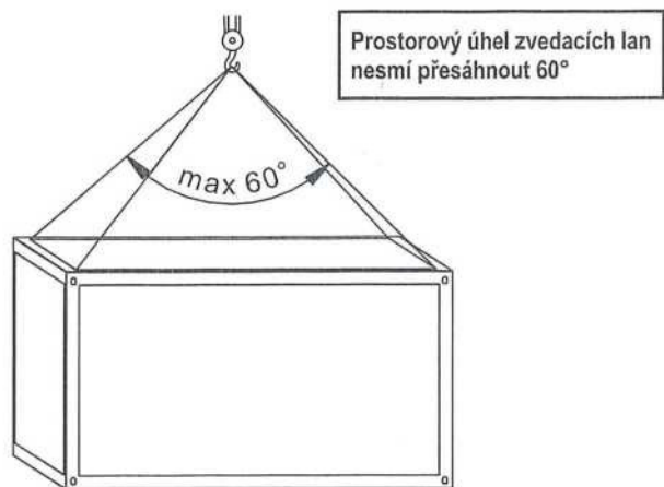
Obr. 1 Uchycení modulu na jeřáb
