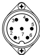
Obr. 3: Zapojení konektorů u přenosné verze M4016-xx-K
