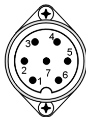
Obr. 3: Zapojení konektorů u přenosné verze M4016-xx-K
