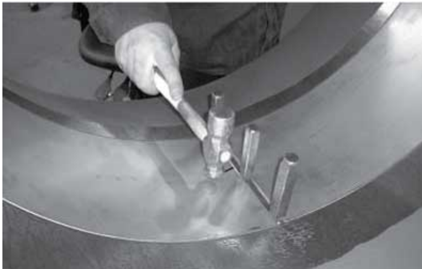
Obrázek 44: Zatlučení třecího kruhu na místo
