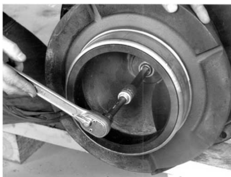
Obrázek 15: Utáhněte šroub oběžného kola.
